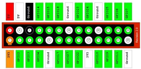
**Beispiel**: Eine LED angeschlossen zwischen Ground (Ansschluss Pin 6) und GPIO4 (Anschluss Pin 7) wird eingeschaltet, wenn der Schwellwert erreicht ist und ausgeschaltet, wenn der Schwellwert unterschritten wird.
